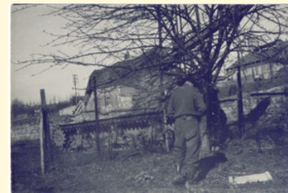
"Hadj Kaddoua qui a relevé le Montmirail." [ C'était un vieux "Grant" M3 char, un survivant des combats en Afrique contre Rommel. Elles ont été transformées en immenses véhicules de dépannage pour les équipages de l'atelier, modèle désigné M2. ]
